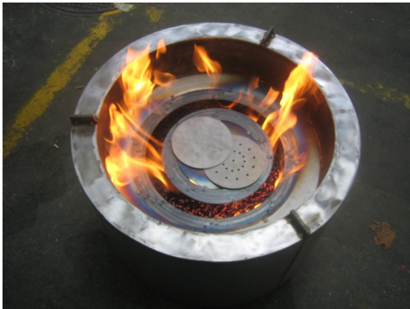
Abb. 2: TLUD-Brenner-Einheit 20 Minuten nach der Zündung. Foto: SG.
