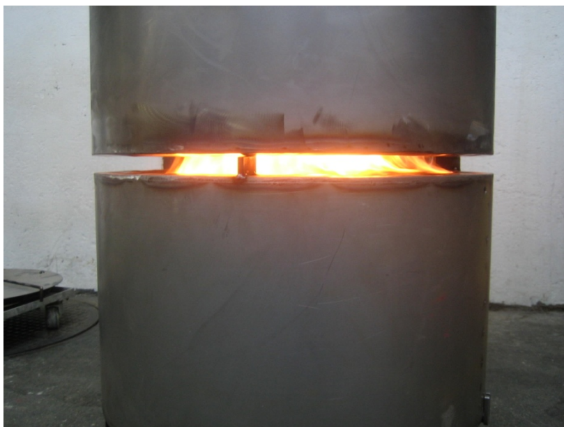
Abb. 3: Abokobi-Ofen mit TLUD-Brenner-Einheit (unten) und Zylinder-Fass (oben). Durch den Spalt dazwischen wird „Tertiärluft“ zum Ausbrand der Pyrolysegase angesaugt. Foto: SG.
